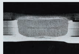
電流値：7000A 加圧力：200daN 通電時間：0,38sec
