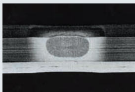
電流値：4000A 加圧力：200daN 通電時間：0,38sec
